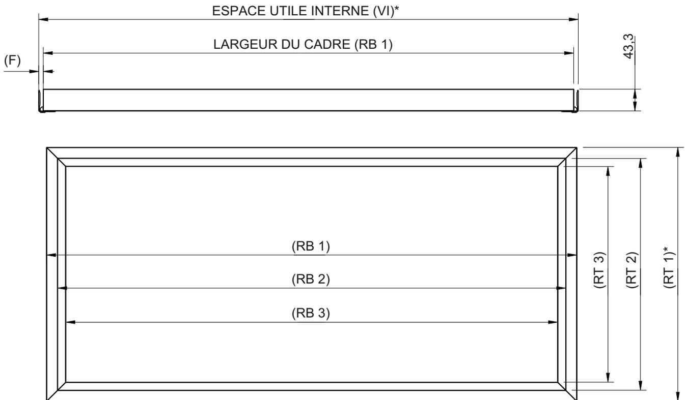
\* Spécifier la profondeur désirée et la longueur de la coulisse pour déterminer la position du clip de fixation
