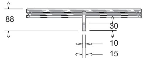
Ripiano per tubo/Boden für Schrankrohr/Shelf for rod/Tablette pour tube armoire
