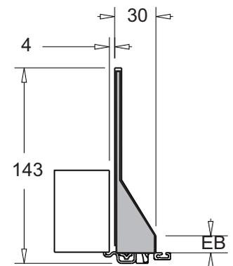
**Calcolare larghezza necessaria/Nötige Breite berechnen/calculate width of the frame/
