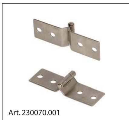
Scharnier gerollt aus Edelstahl 1.4301 60 x 20 x 1 mm mit 4 Bohrungen Ø 4,5 mm
