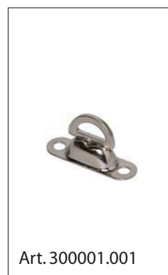
Drehverschluß aus Edelstahl 1.4016 41 x 11 x 12,5 mm
